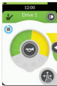
La commande **LiNX** avec écran LCD touch screen offre la possibilité d'avoir accès à un choix énorme de fonctions (inclinaison de l'assise et du dossier, éclairage) avec une visualisation directe sur l'écran pour plus de confort et de facilité d'utilisation.
