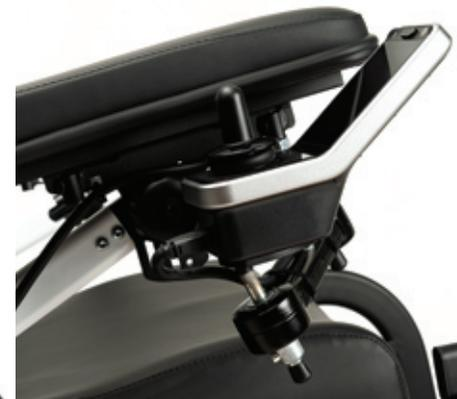
SE53Z - Commande pivotante avec abaissement pour accès à la table
